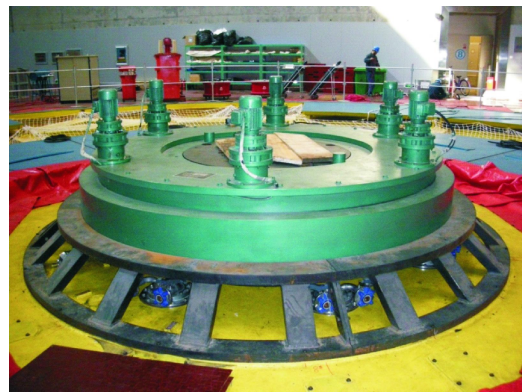
图1 电机齿轮传动的自动盘车装置图
