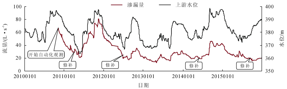
图3 量水堰实测面板坝渗流量过程线图
