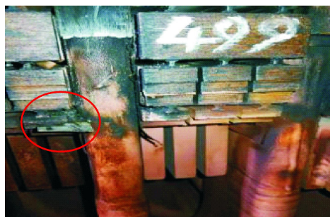
图1 故障点铁心窜片图
